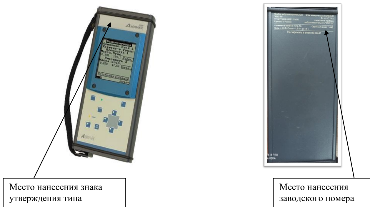
Рисунок 1 – Внешний вид прибора виброизмерительного «АГАТ-М».
