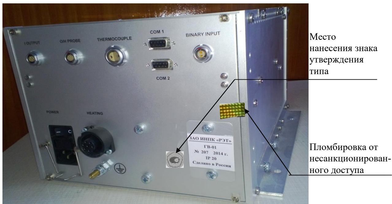
Рисунок 2 – Внешний вид измерительного блока газоанализатора. Вид сзади
