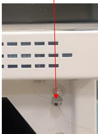
Рисунок 10 – Схема пломбировки корпуса управляющего блока
