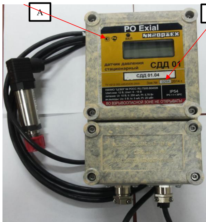
б) датчики с выносным тензомодулем
