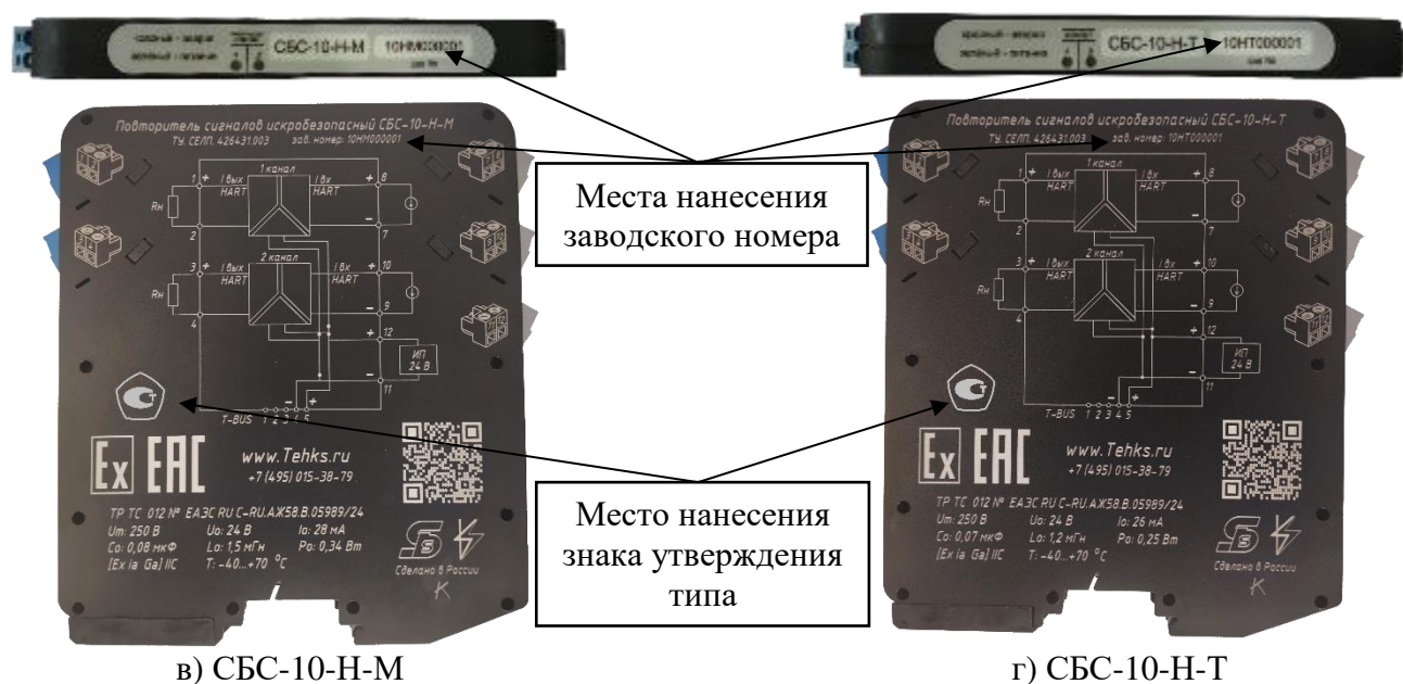
Рисунок 1 – Общий вид повторителей с указанием мест нанесения знака утверждения типа, заводского номера
