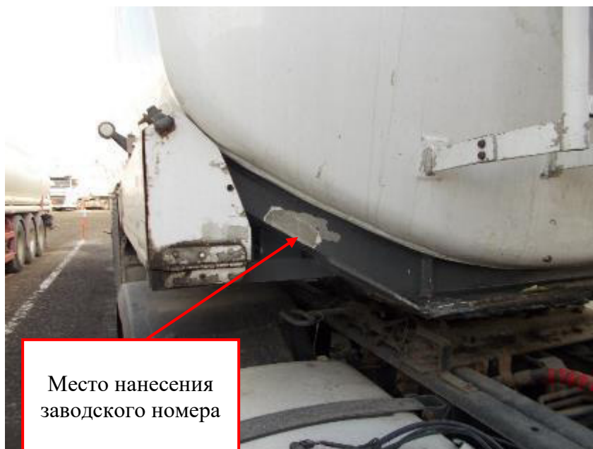
Рисунок 2 – Место нанесения заводского номера полуприцепа-цистерны STOKOTA OPL 38-3
