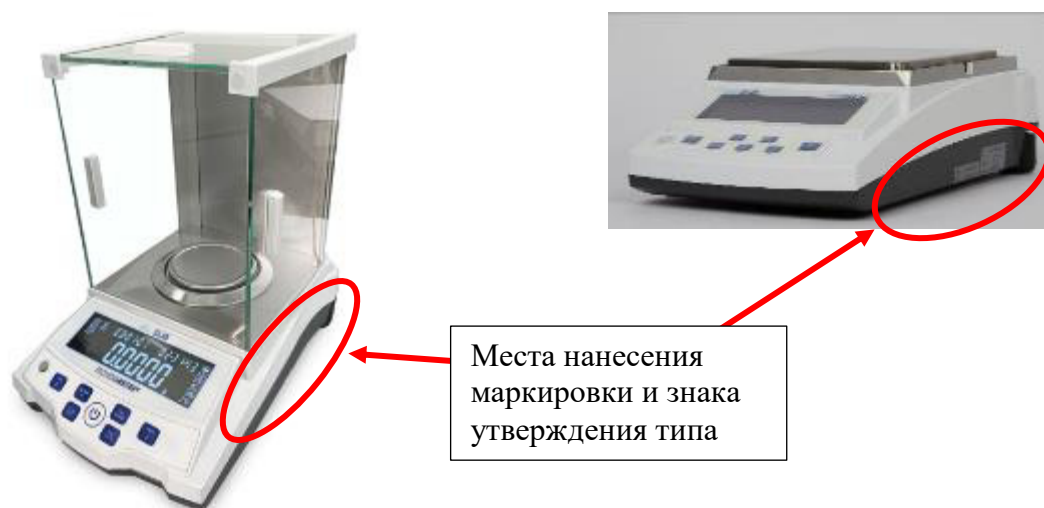
Рисунок 4 – Места нанесения маркировки и знака утверждения типа
