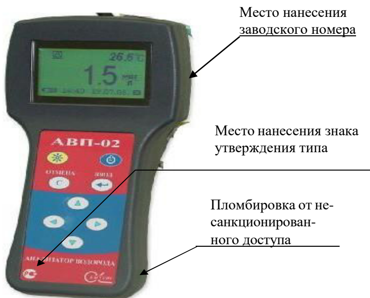
Рисунок 1 – Внешний вид измерительного преобразователя анализатора в портативном исполнении
