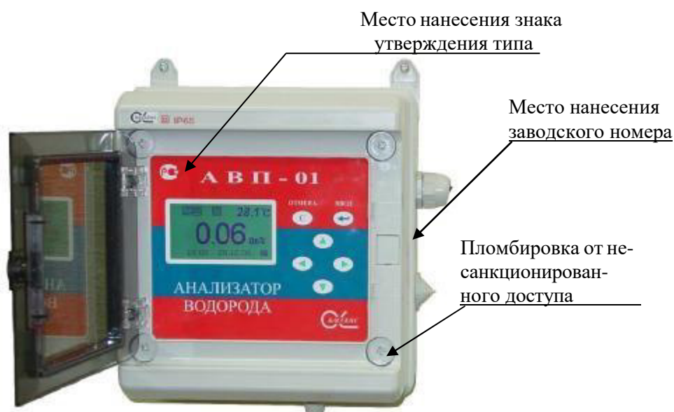
Рисунок 2 – Внешний вид измерительного преобразователя анализатора в стационарном исполнении
