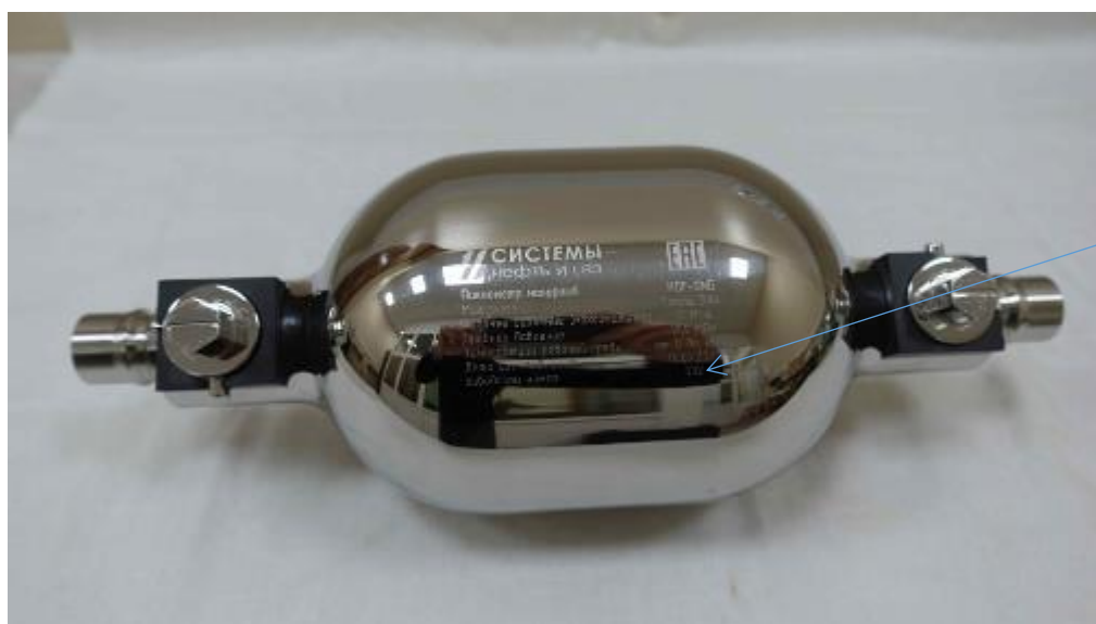
Рисунок 1 – Общий вид пикнометра с указанием места нанесения заводского номера
