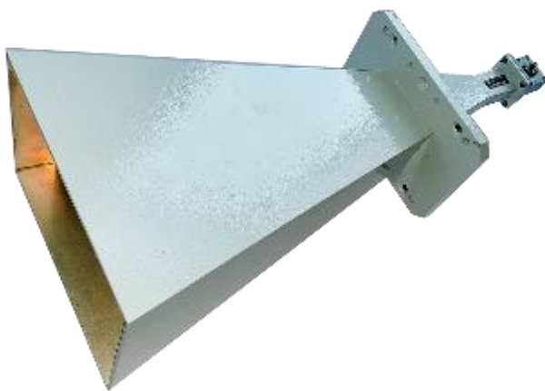
Рисунок 8 – Внешний вид рабочего эталона для поверки измерительных антенн П1-139/3
