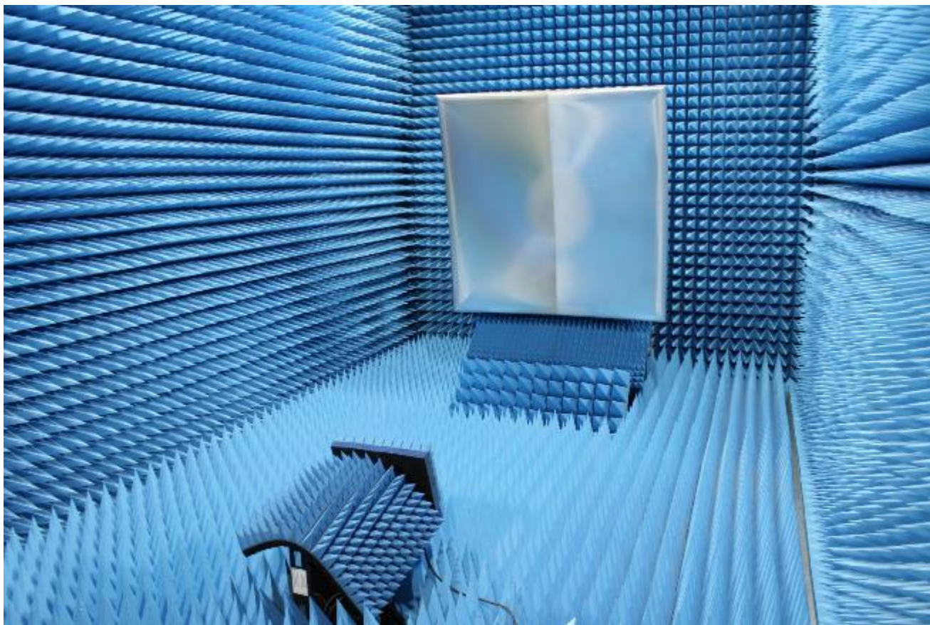
Рисунок 1 – Внешний вид зеркала (рефлектора) радиоколлиматора (на заднем плане) и позиционера облучателя (на переднем плане)
