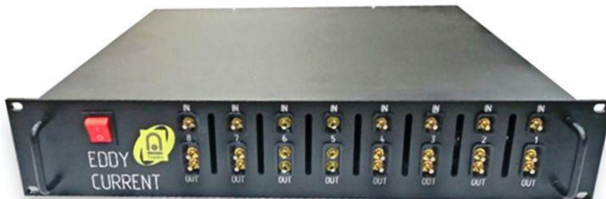
Рисунок 1 – Общий вид дефектоскопов вихретоковых многоканальных «ЭМД-2»
