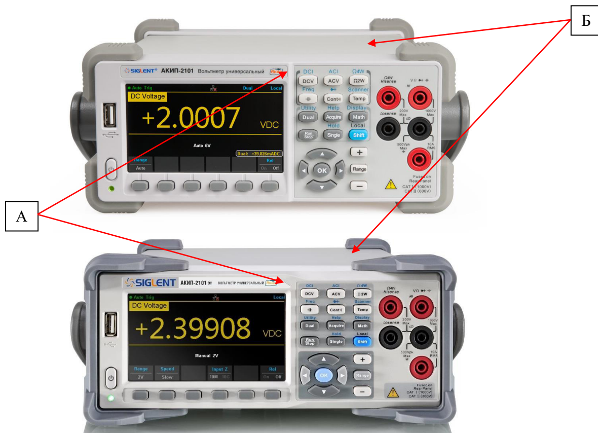
Рисунок 1 – Внешний вид вольтметров и место нанесения знака утверждения типа (А) и знака поверки (Б)
