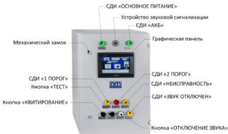
Рисунок 1 – Общий вид одного из исполнений ШКУЗ-ППП в составе СКЗ
