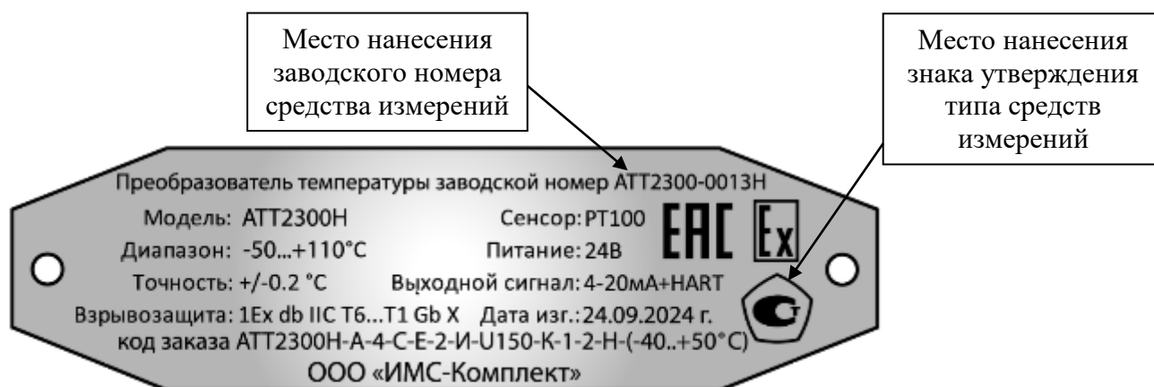
Рисунок 2 – Места расположения заводского номера преобразователей и нанесения знака утверждения типа
