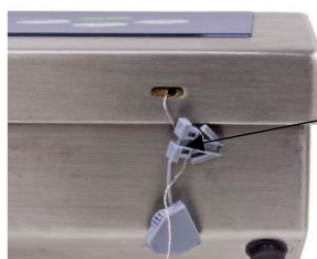
Рисунок 3 – Схема пломбировки терминала от несанкционированного доступа
