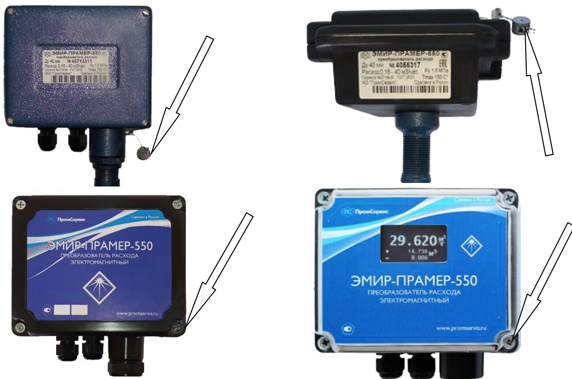
Рисунок 2 – Схема пломбировки от несанкционированного доступа, обозначение места нанесения знака поверки преобразователей
