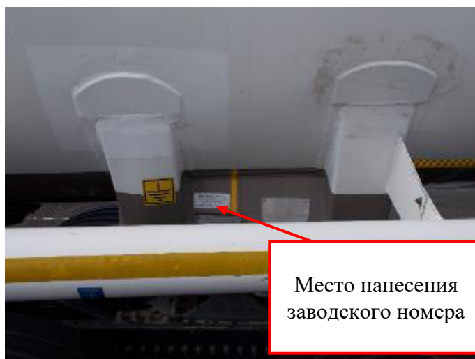
Рисунок 2 – Место нанесения заводского номера полуприцепа-цистерны KAESSBOHRER STB 42/10-24
