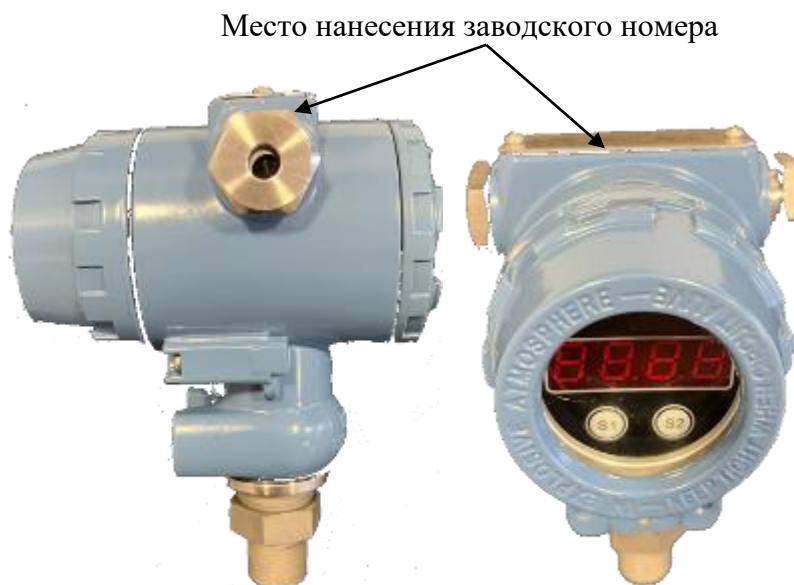
Рисунок 1 – Внешний вид датчиков и место нанесения заводского номера
