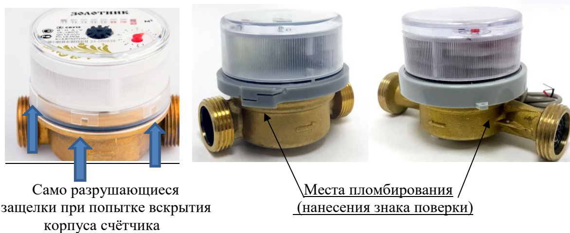
Рисунок 2 – Схема защиты от несанкционированного доступа, обозначение места нанесения знака поверки
