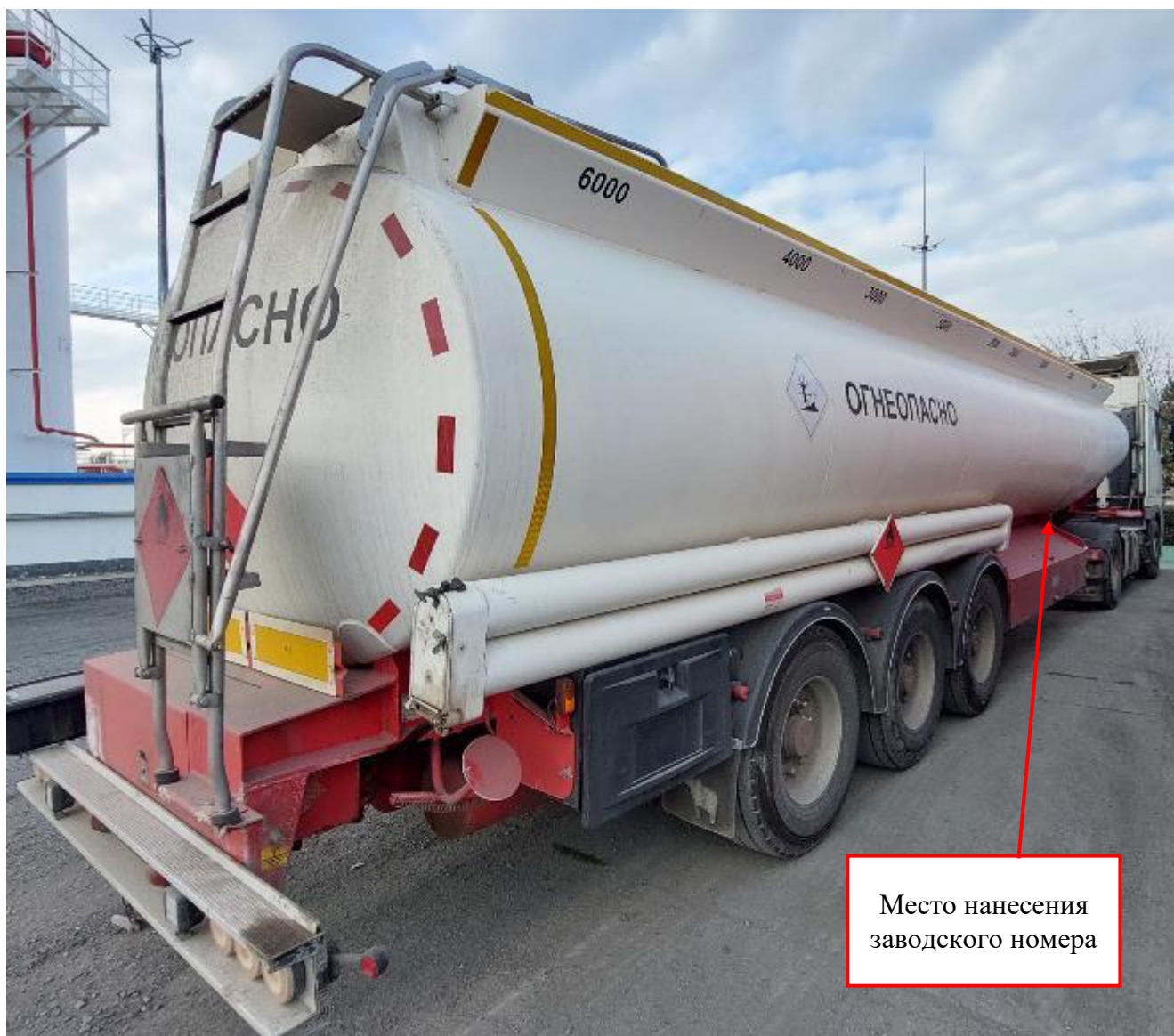
Рисунок 1 – Общий вид полуприцепа-цистерны MERCERON M343SRRP0 с заводским номером VF9M343SR10435029 с указанием места нанесения заводского номера
