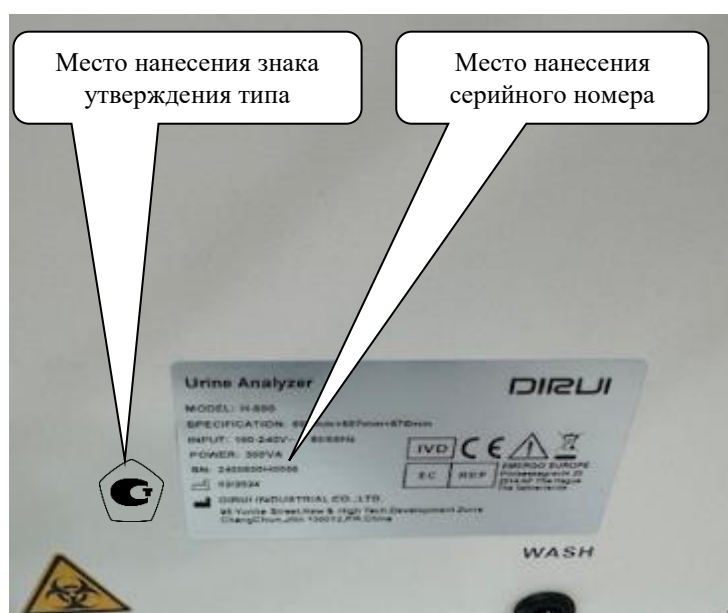
Рисунок 2 – Схема пломбировки от несанкционированного доступа, место нанесения серийного номера и знака утверждения типа
