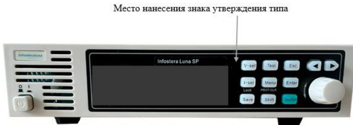
Рисунок 1 – Общий вид и место нанесения знака утверждения типа источников InfosteraLuna SP600-15-60; SP900-15-60; SP600-60-15; SP900-60-15; SP600-100-10; SP900-100-10; SP600-150-6; SP900-150-6; SP600-600-015; SP900-600-015; SP600-36-30; SP900-36-30; SP600-80-12; SP900-80-12; SP600-120-8; SP900-120-8; SP600-300-3; SP900-300-3
