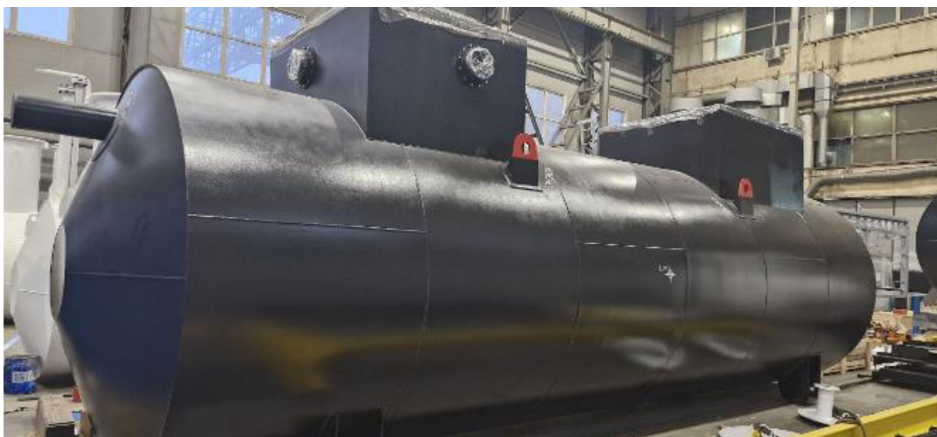
Рисунок 3 – Общий вид резервуара РГСП-Н50-1900А1К0-2-Б-2-У-С0 с зав.№ 8661
