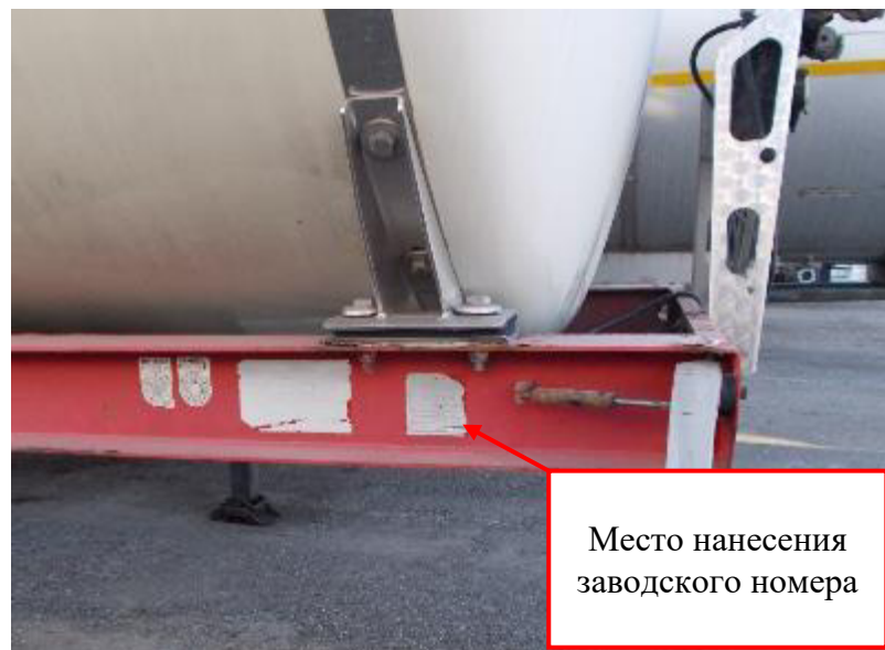
Рисунок 2 – Место нанесения заводского номера полуприцепа-цистерны BERGER
