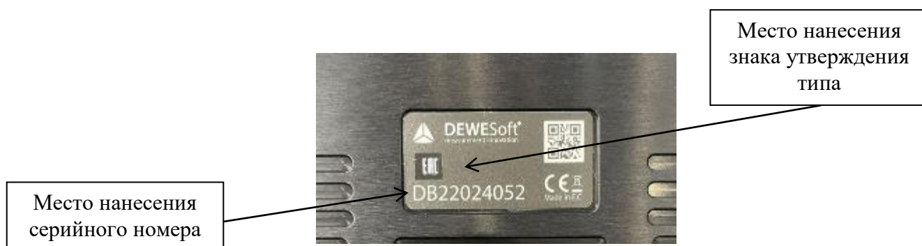
Рисунок 6 – Маркировочная табличка модулей с указанием места нанесения знака утверждения типа, места нанесения серийного номера
