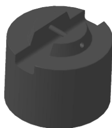
Рисунок 1 – Общий вид гирь в форме цилиндра с рукояткой и посадочными местами для штабелирования (слева) и головкой (справа)
