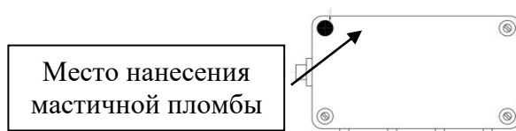
Рисунок 3 – Схема пломбировки корпуса преобразователя
