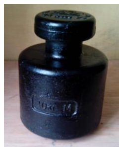
Рисунок 1 – Общий вид гирь в форме цилиндра с рукояткой и посадочными местами для штабелирования (слева) и головкой (справа)
