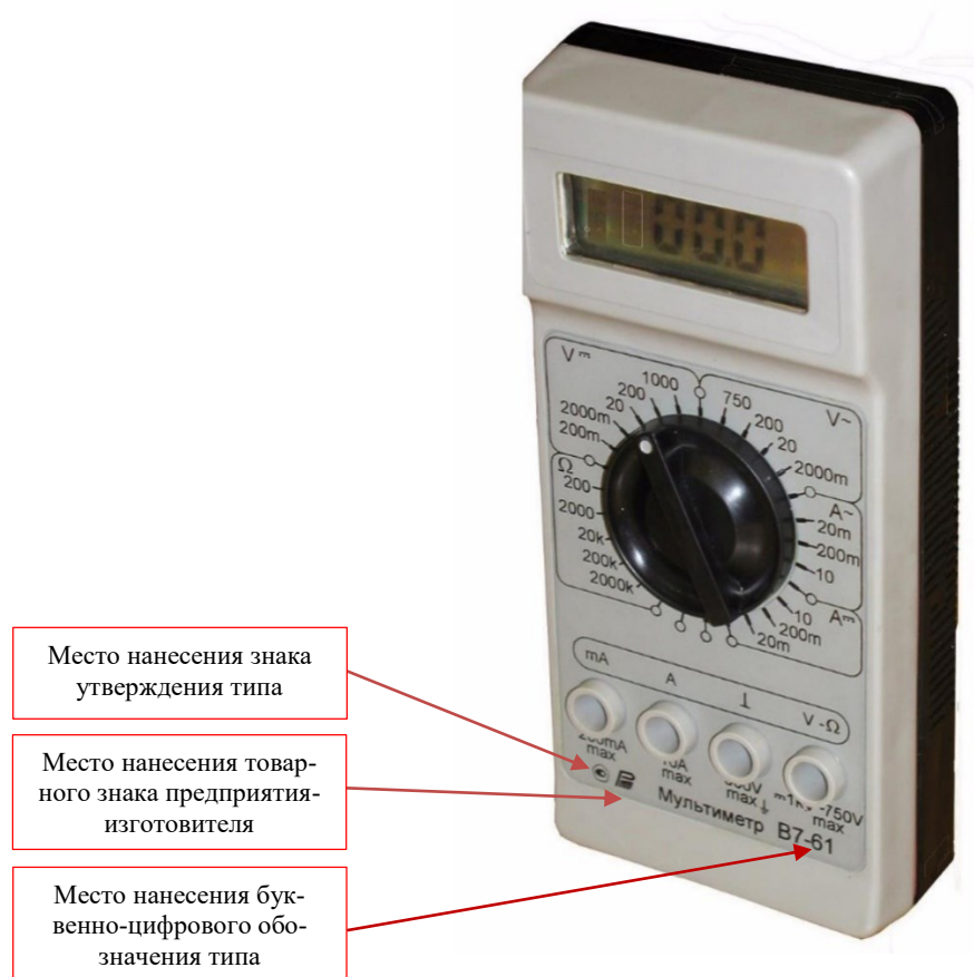
Рисунок 1 – Фотография прибора с указанием мест нанесения буквенно-цифрового обозначения типа, знака утверждения типа, товарного знака предприятия-изготовителя
