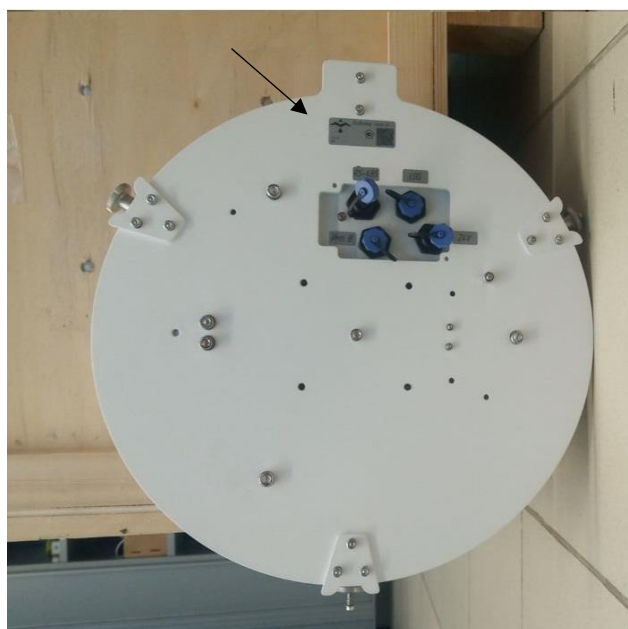
Рисунок 2 – Место нанесения заводского номера, знака утверждения типа
