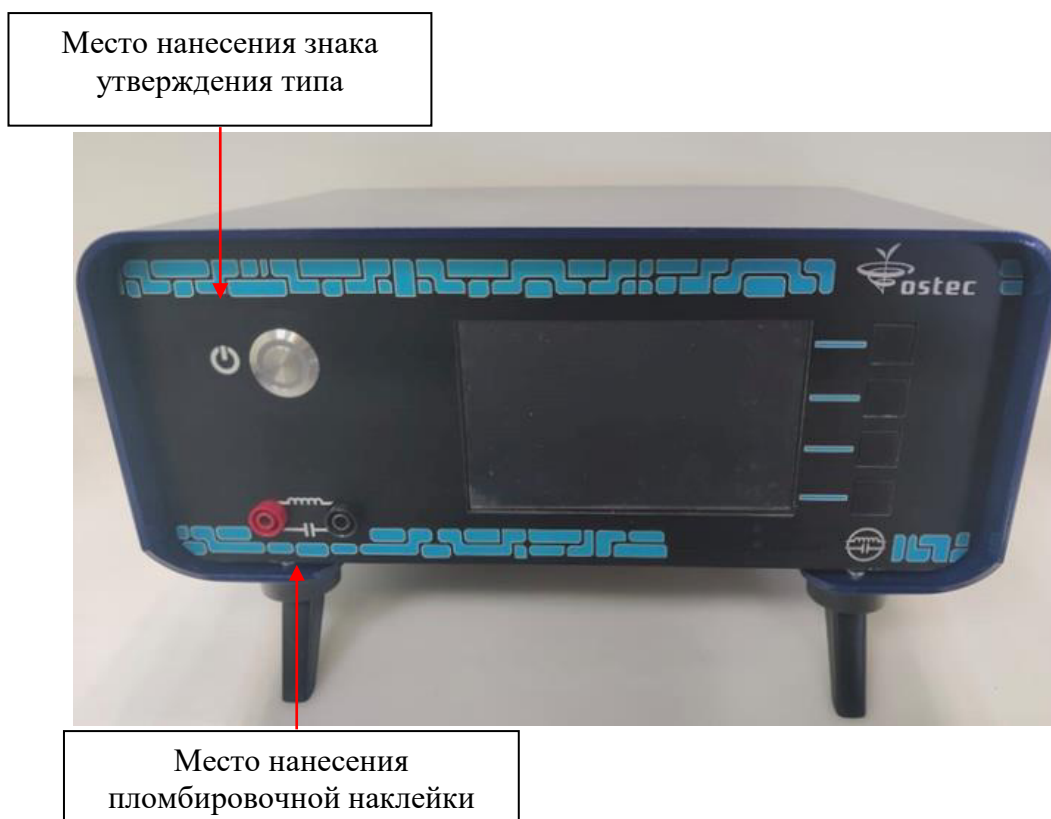
Рисунок 1 – Общий вид LC-метров с указанием места ограничения доступа к местам настройки и места нанесения знака утверждения типа (вид спереди)
