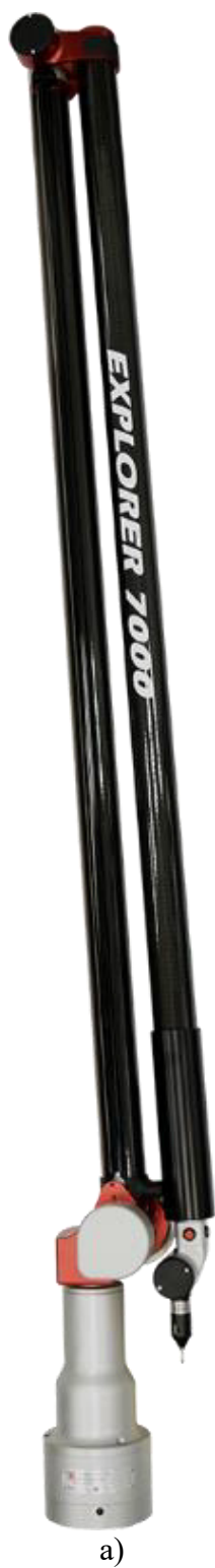
Рисунок 4 – Общий вид Машин координатно-измерительных портативных Tomelleri Engineering серии EXPLORER: а) с 6 осями вращения; б) с 7 осями вращения
