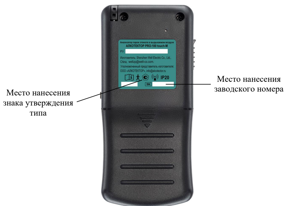
Рисунок 4 – Места нанесения заводского номера и знака утверждения типа
