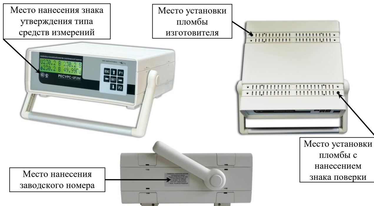
Рисунок 1 – Общий вид приборов модификаций «Ресурс-UF2» и «Ресурс-UF2С» с указанием места ограничения доступа к местам настройки (регулировки), места нанесения знака утверждения типа средств измерений и места нанесения заводского номера
