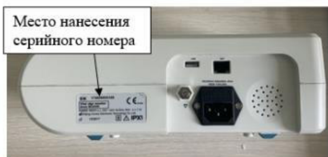
Рисунок 3 – Маркировка и место нанесения серийного номера на основной блок MD2000B
