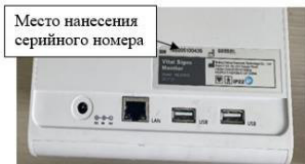
Рисунок 4 – Маркировка и место нанесения серийного номера на основной блок MD2000C
