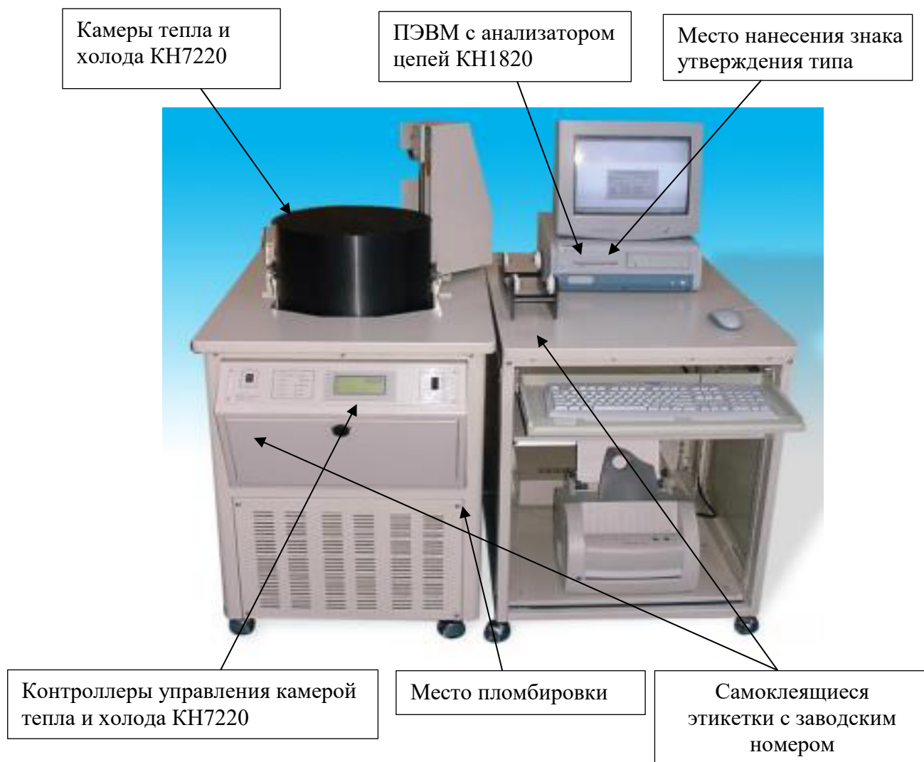
Рисунок 1 – Общий вид установки место нанесения знака утверждения типа, место пломбировки от несанкционированного доступа
