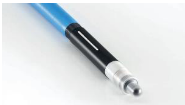
Рисунок 9 – Ионизационная камера типа 31025
