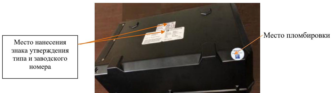
Рисунок 3 – Схема пломбировки от несанкционированного доступа, место нанесения заводского номера и знака утверждения типа счетчиков аэрозольных частиц Lighthouse модификации ApexZ (задняя панель корпуса)
