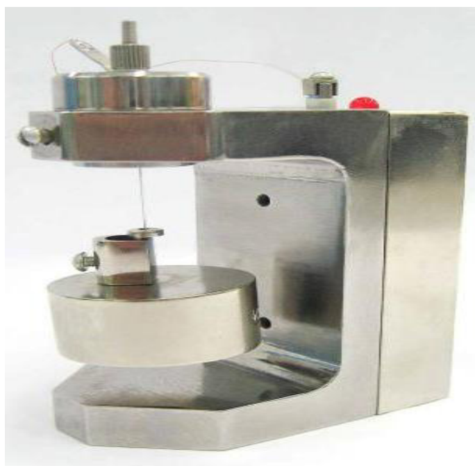
Рисунок 1 – Конструктивное устройство комплекта поверителя задатчиков давления КРЗД-01 (в сборе)
