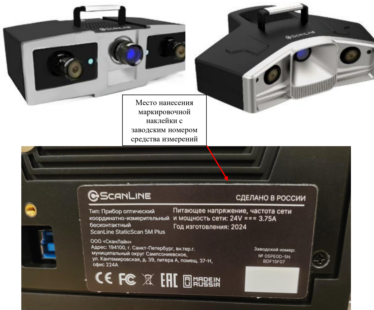
а) б) в) Рисунок 1 – Общий вид приборов оптических координатно-измерительных бесконтактных ScanLine StaticScan модификаций: а) ScanLine StaticScan 5M Plus; б) ScanLine StaticScan 13M; в) место нанесения маркировочной наклейки
