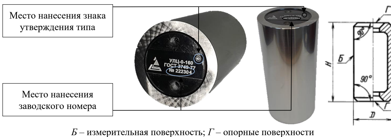
Р и с у н о к 3 – Общий вид угольников УЛЦ, обозначение основных размеров и поверхностей
