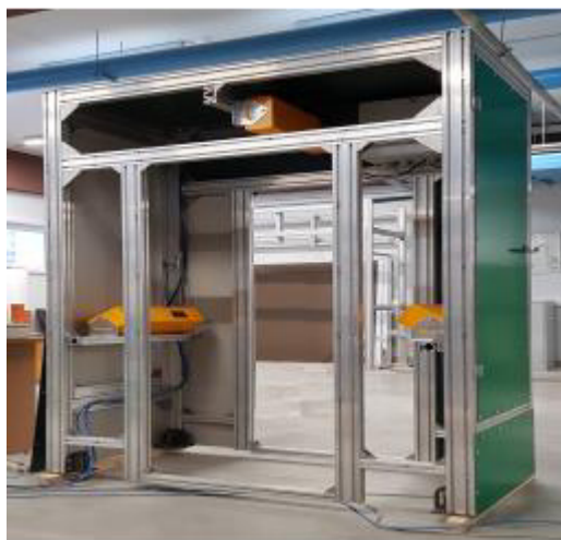
Рисунок 1 – Общий вид измерителей геометрических параметров бревен БЕКТОР-3D
