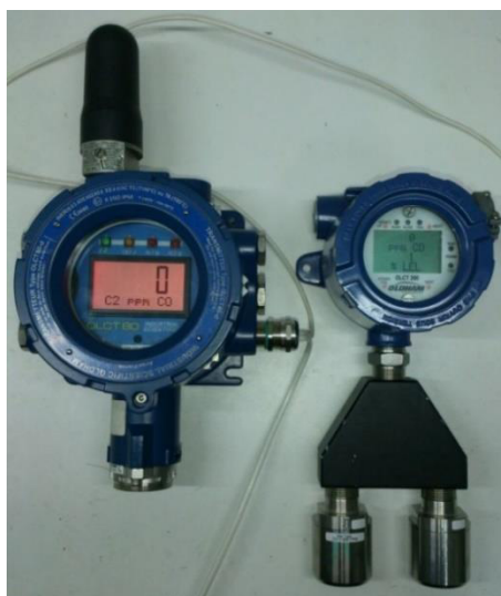
р) OLCT 80Wireless с подключенным в качестве двух дополнительных измерительных каналов OLCT 200
