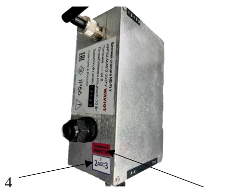
Базовая станция NB-Fi У
