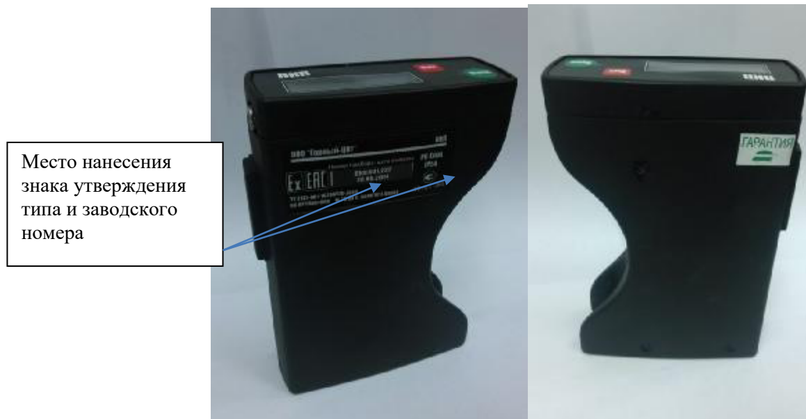
Рисунок 1 – Внешний вид прибора, место пломбировки корпуса, место нанесения знака утверждения типа и заводского номера
