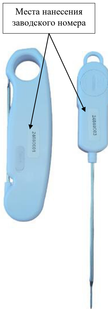
Рисунок 2 – Общий вид термометров с указанием мест нанесения заводского номера
