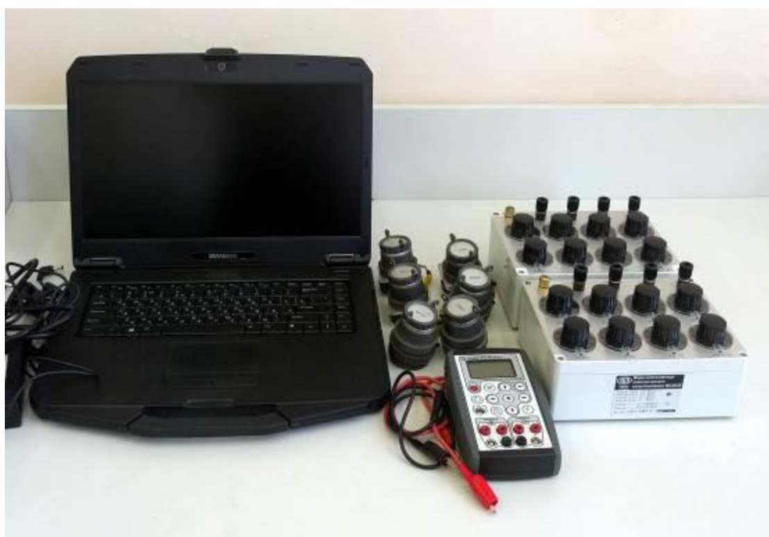
Рисунок 4 – Комплект проверочной аппаратуры СИП 5004-КПА
