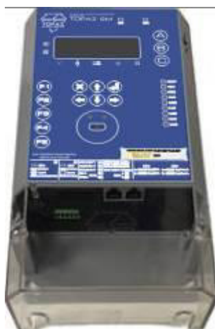
Рисунок 2 – Общий вид счетчиков с цифровыми входами
