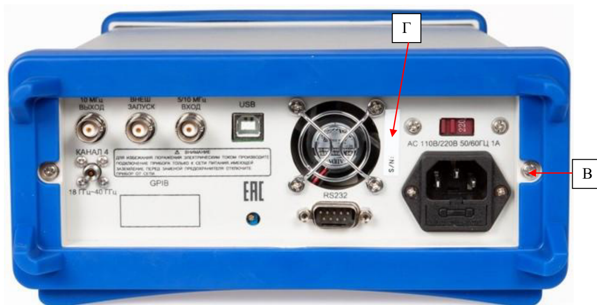
Рисунок 3 – Вид задней панели частотомеров АКИП-5109/2 и АКИП-5109/4, схема пломбировки от несанкционированного доступа (В) и место нанесения серийного номера (Г)
