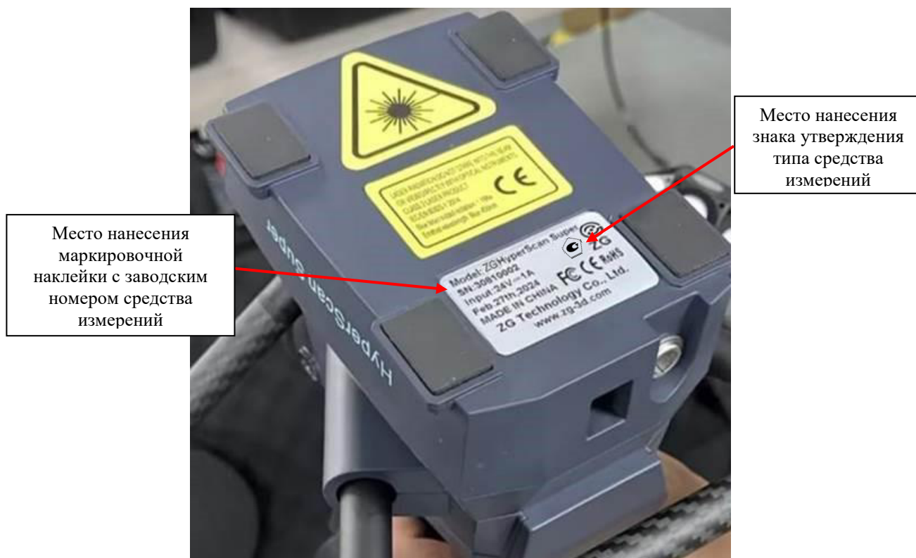
Рисунок 2 - Место расположения маркировочной наклейки с указанием заводского номера сканера и место нанесения знака утверждения типа
