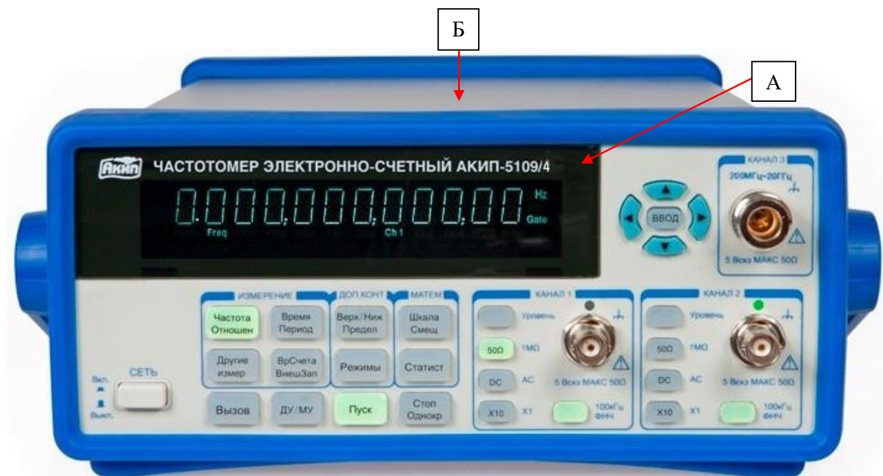
Рисунок 1 – Общий вид модели частотомеров АКИП-5109 с местами для нанесения знака утверждения типа (А) и знака поверки (Б)
