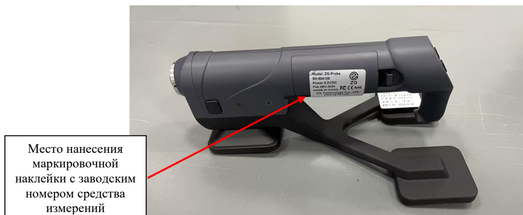
Рисунок 4 - Место расположения маркировочной наклейки с указанием заводского номера щупа
