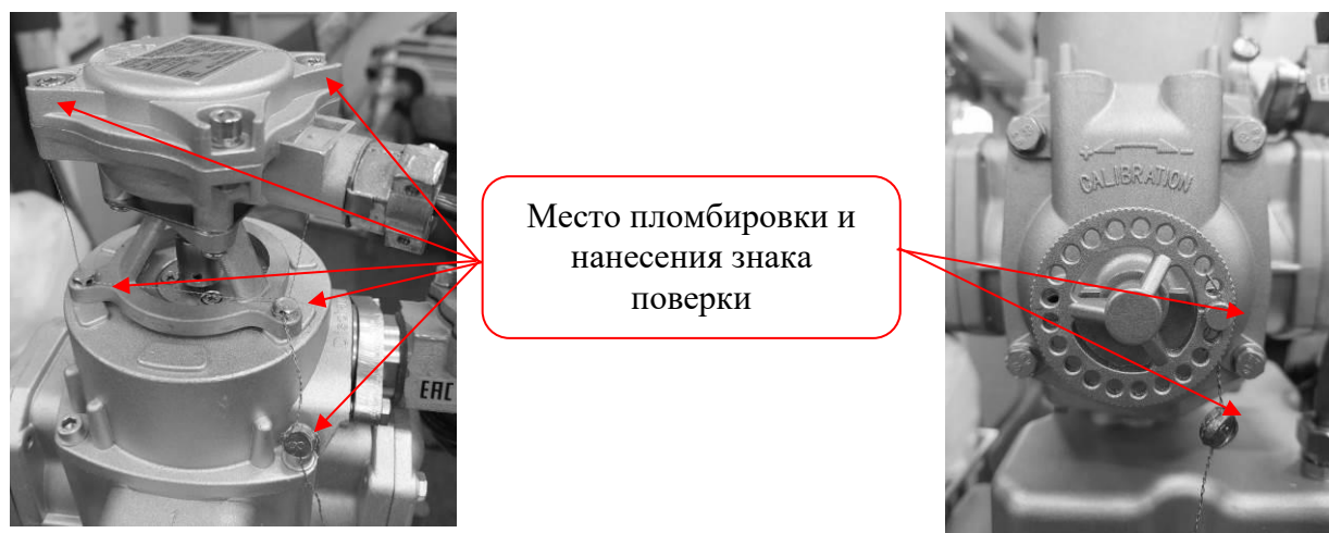
Рисунок 19 – Схема пломбирования или нанесения знака поверки на измеритель объема поршневой RSJ-50
