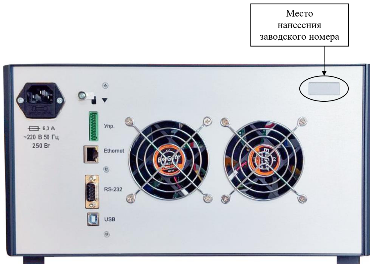
Рисунок 4 - Фотография калибратора с указанием места нанесения заводского номера
