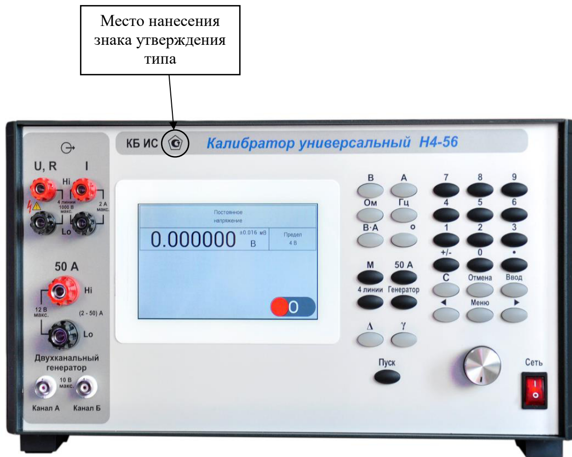
Рисунок 3 - Фотография калибратора с указанием места нанесения знака утверждения типа
