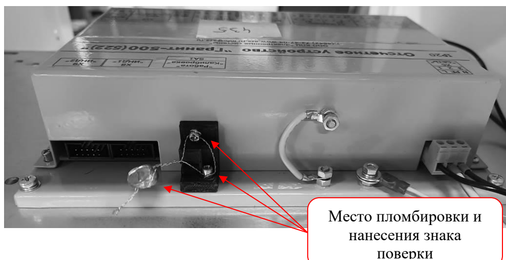
Рисунок 14 – Схема пломбирования или нанесения знака поверки на электронно-вычислительное устройство Гранит -500
