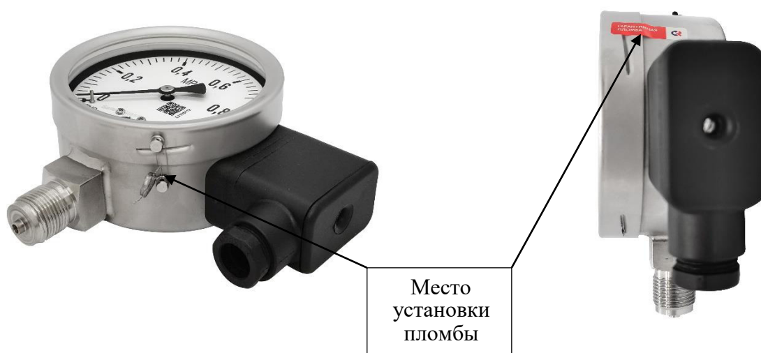
Рисунок 2 - Схема пломбировки манометров от несанкционированного доступа
