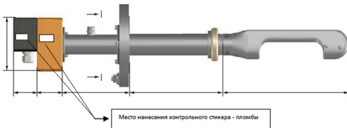
Рисунок 2 – Схема пломбирования. Блок электроники
