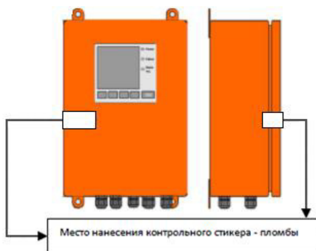
Рисунок 2 – Схема пломбирования. Блок электроники
