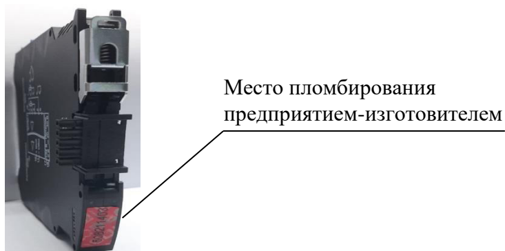
Рисунок 5 – Схема пломбировки от несанкционированного доступа
