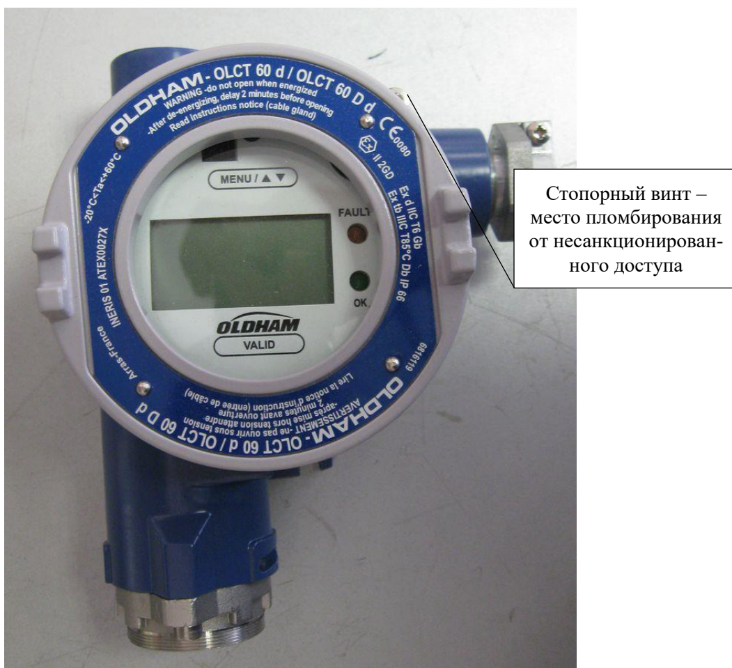
Рисунок 2 – Схема пломбирования датчиков (на примере OLCT 60)
