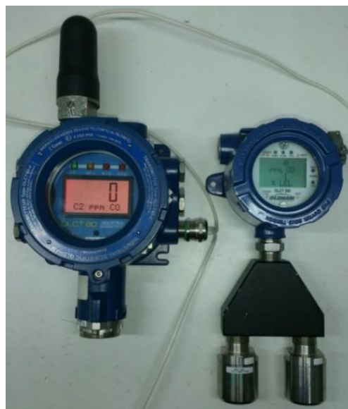
м) OLCT 80Wireless с подключенным в качестве двух дополнительных измерительных каналов OLCT 200
