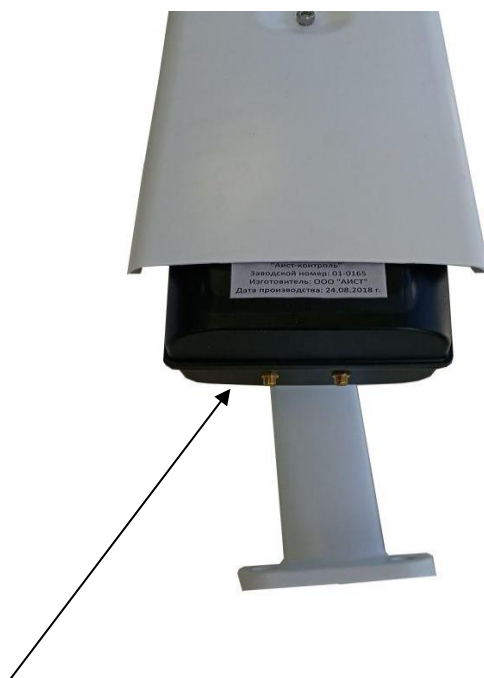
Рисунок 3 – Схема пломбировки от несанкционированного доступа и маркировки комплексов «Аист-контроль» мод. 1 и «Аист-контроль» мод. 2
