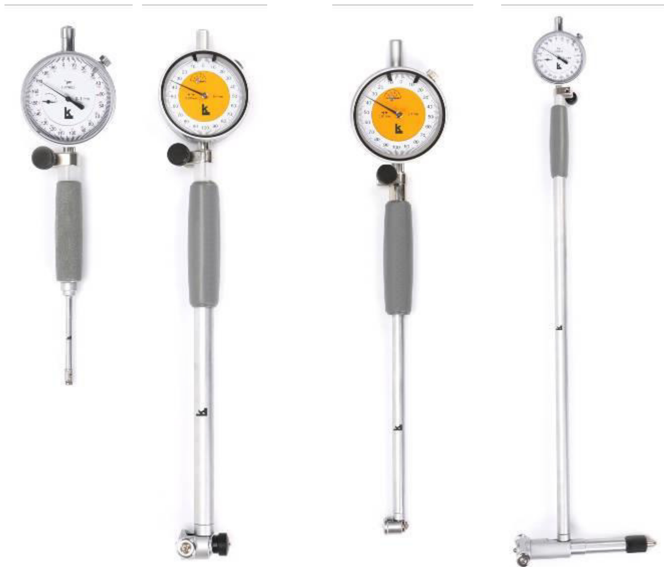
Рисунок 1 – Общий вид нутромеров модификации НИ-ПТ
