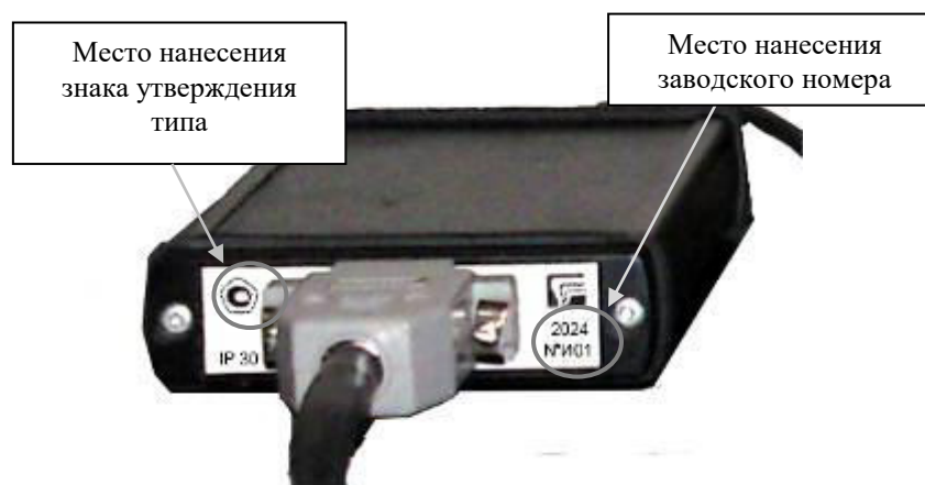
Рисунок 4 – Общий вид ИСШР-02 со стороны передней панели с указанием мест нанесения заводского номера и знака утверждения типа
