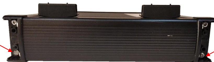
Рисунок 3 – Схема пломбировки измерителя удлинения световодов ИД-2-3В
