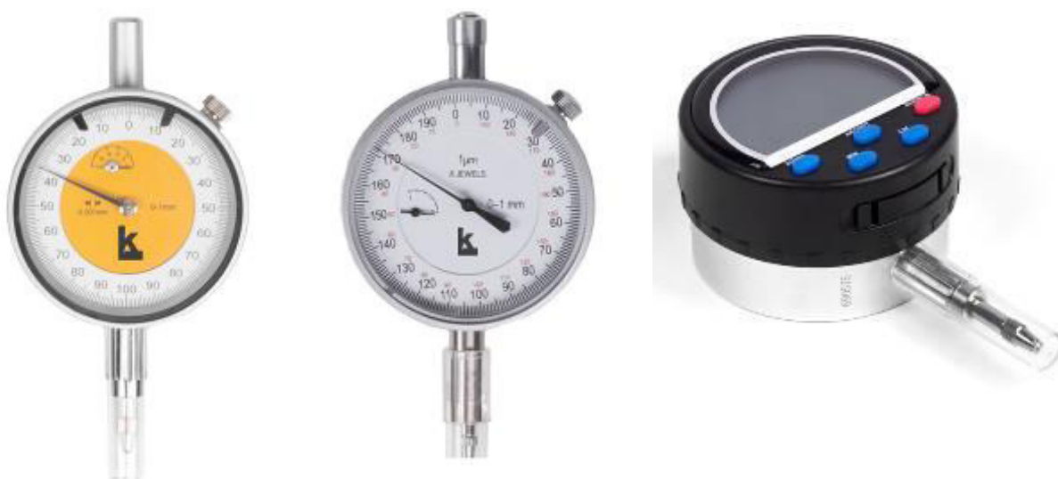
Рисунок 4 – Общий вид отсчетных устройств нутромера
