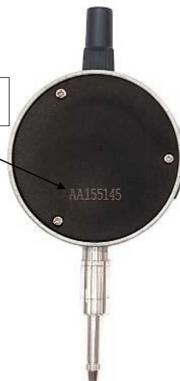
Рисунок 2 – Общий вид глубиномеров модификации ГИЦ и место нанесения заводского номера
