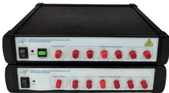
Рисунок 1 – Общий вид измерителя удлинения световодов ИД-2-3В
