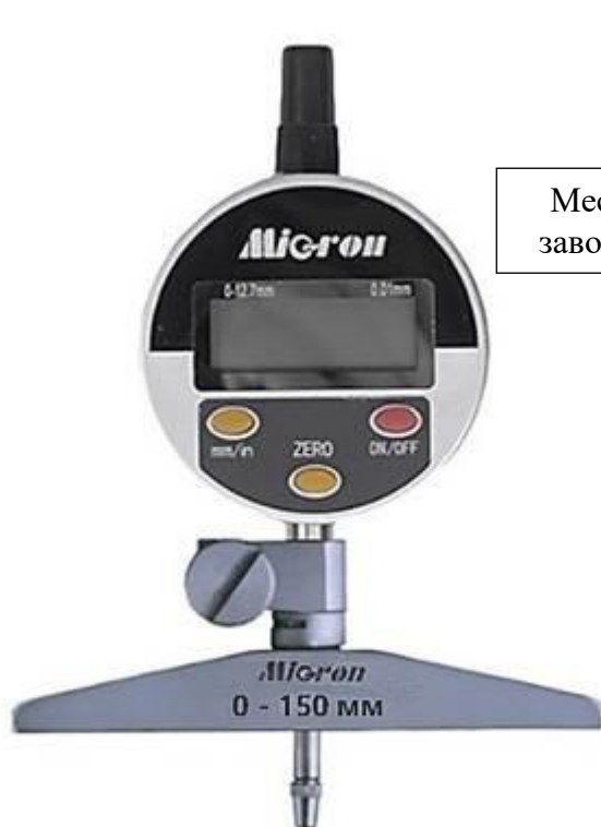
Рисунок 2 – Общий вид глубиномеров модификации ГИЦ и место нанесения заводского номера
