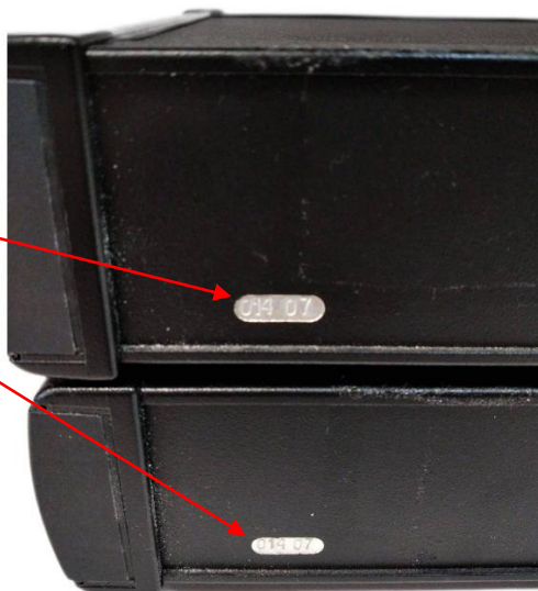
Рисунок 2 – Места нанесения заводского номера измерителя удлинения световодов ИД-2-3В
