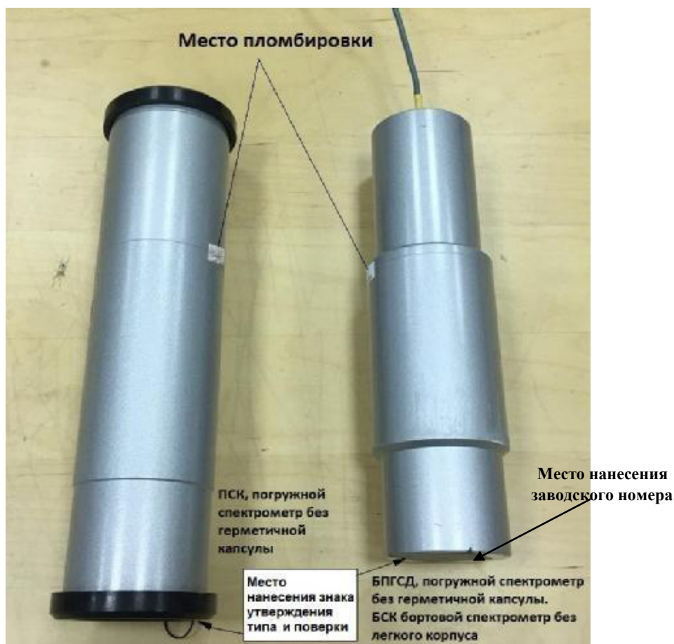
Рисунок 3 – Схема пломбировки от несанкционированного доступа, обозначение места нанесения знака поверки, заводского номера и знака утверждения типа
