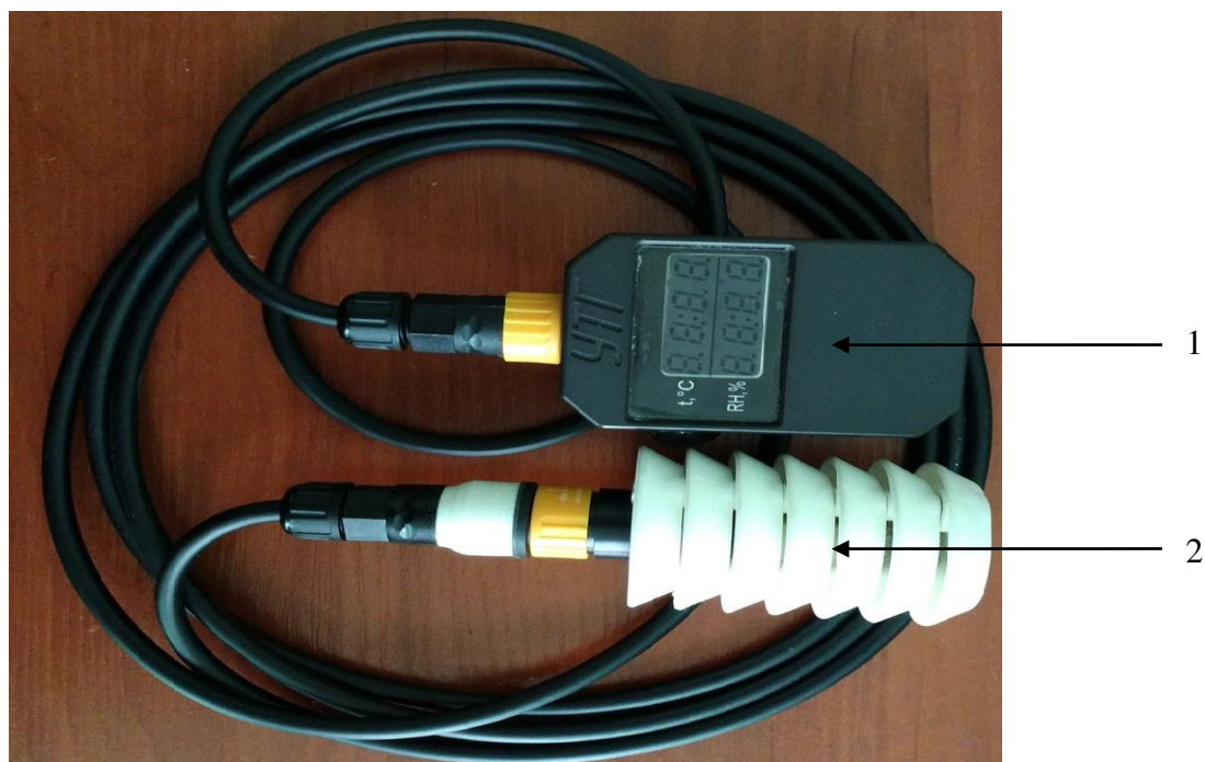
Рисунок 1 – Общий вид термогигрометров «УТГ» 1 - модуль отображения, 2 – модуль измерений
