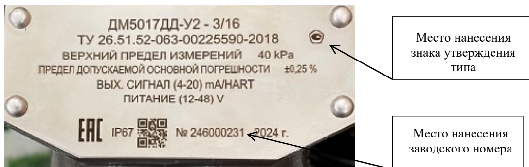
Рисунок 7 – Место нанесения заводского номера и знака утверждения типа на датчик
