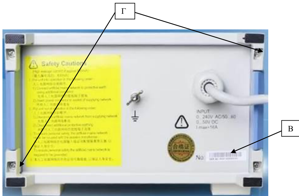
Рисунок 2 – Вид задней панели эквивалентов сети с местами нанесения наклейки с серийным номером (В) и пломбировки (Г)
