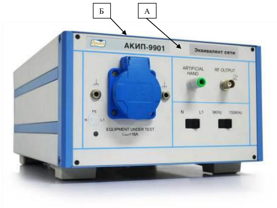
Рисунок 1 – Общий вид эквивалентов сети с местами нанесения знака утверждения типа (А), знака поверки (Б)
