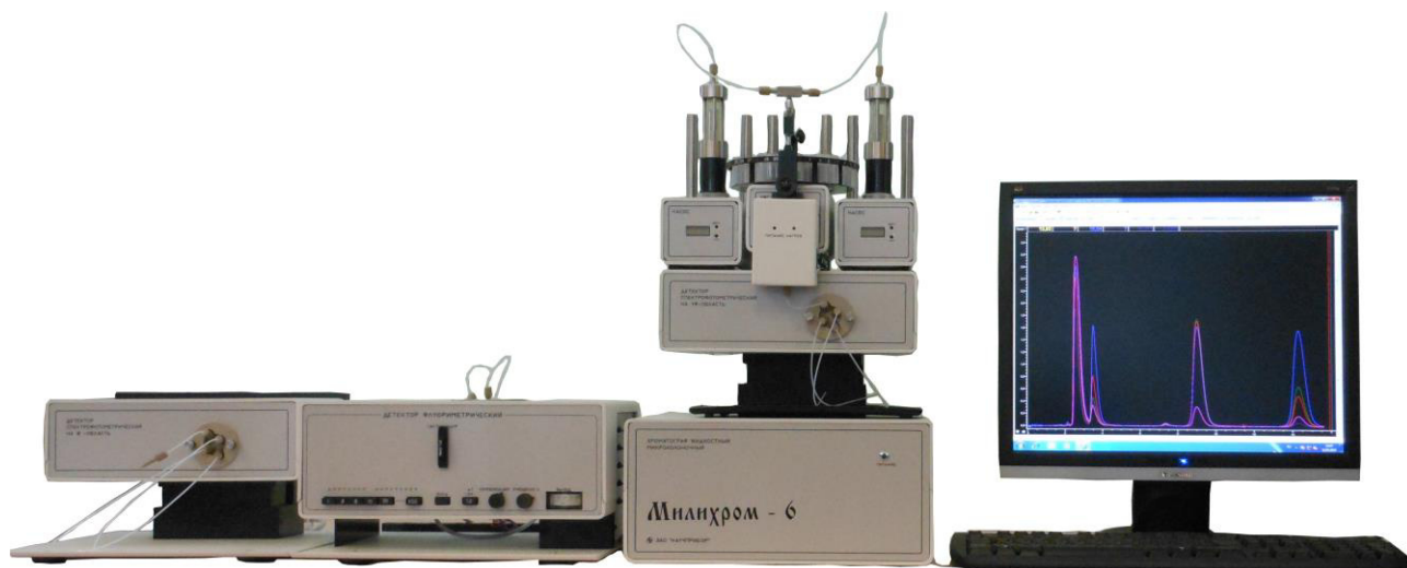
Рисунок 1 – Общий вид хроматографа жидкостного микроколоночного «Милихром-6»
