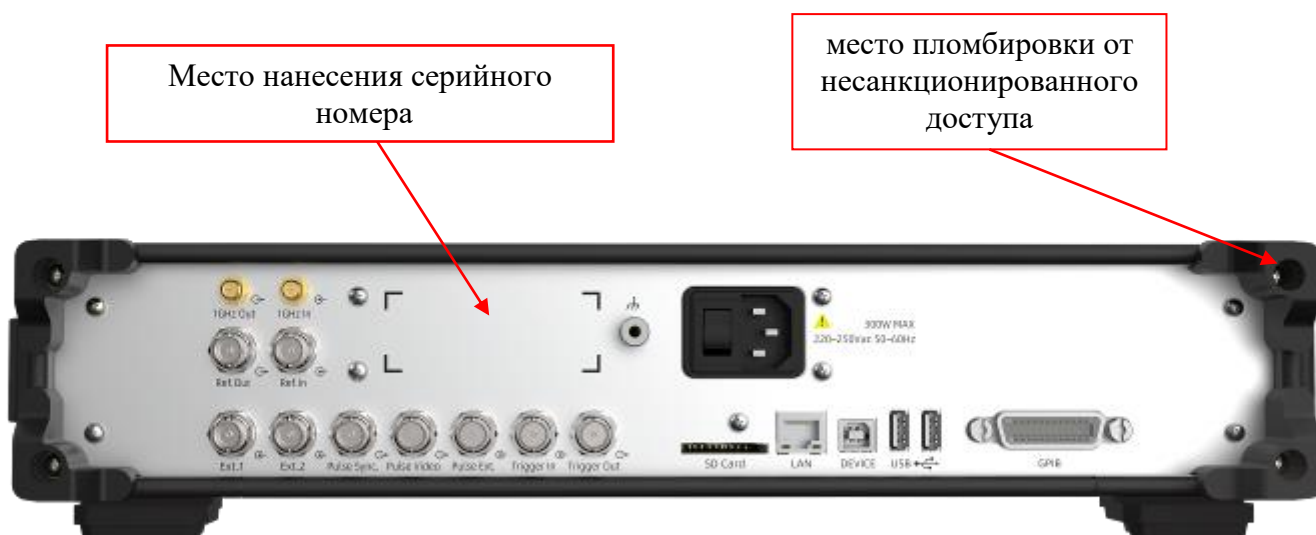
Рисунок 2 – Схема пломбировки от несанкционированного доступа
