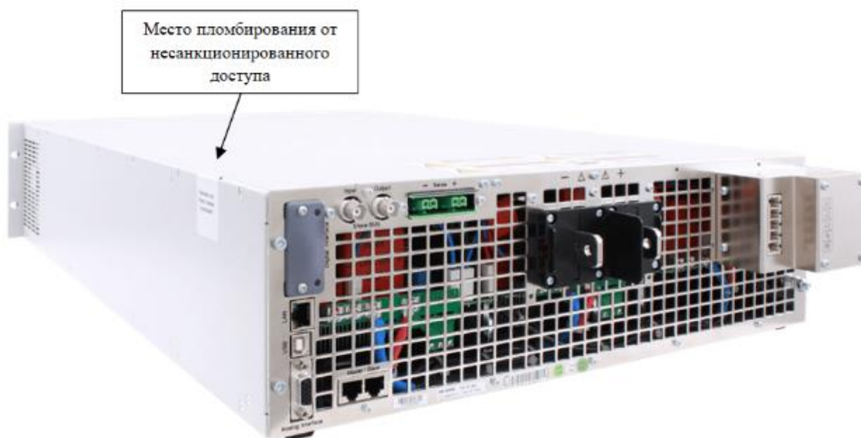
Рисунок 5 – Схема пломбирования от несанкционированного доступа
