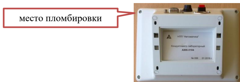
Рисунок 10 - Схема пломбирования АЖК-3104
