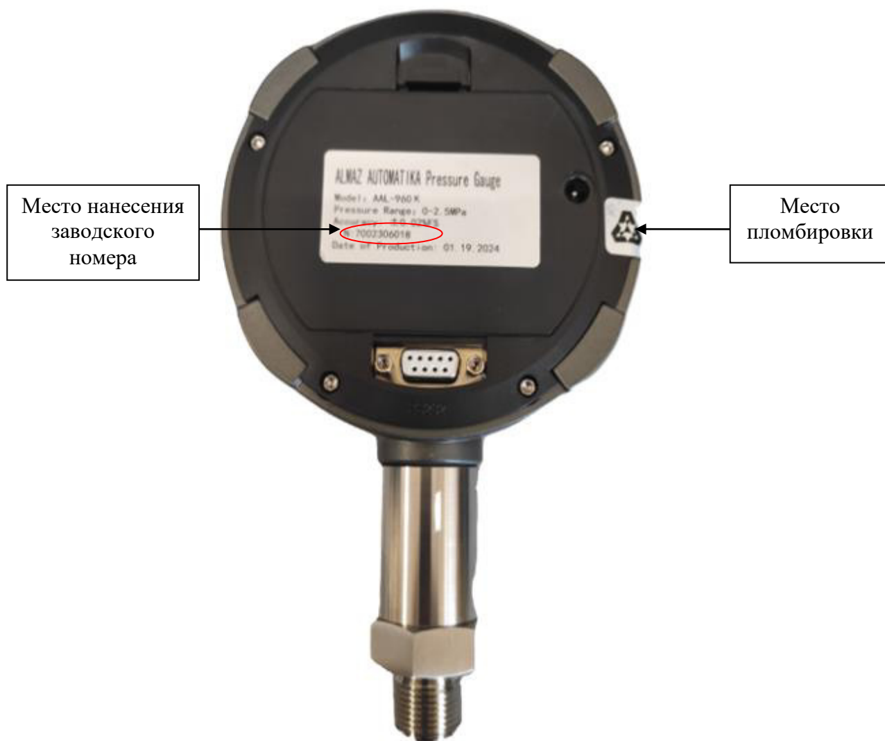
Рисунок 3 – Пример размещения маркировочной таблички и места пломбировки корпуса
