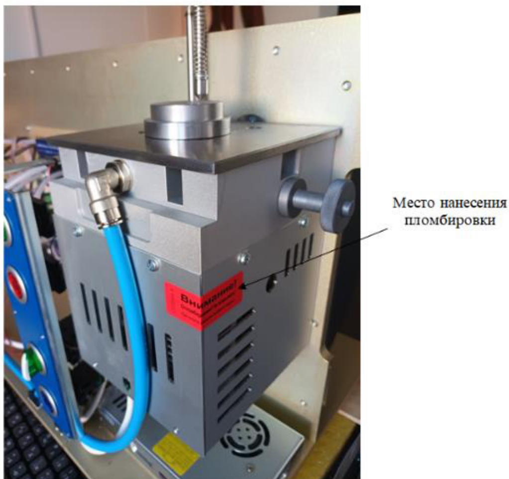
Рисунок 2 – Схема пломбировки от несанкционированного доступа
