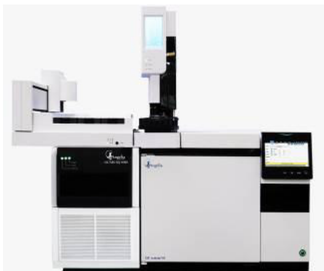
Рисунок 5 – Общий вид хроматографа газового Angelia GC system модификации Angelia GC system V6 с масс-селективным детектором
