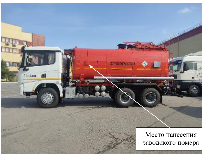
Рисунок 2 – Общий вид АТЗ с указанием нанесения заводского номера
