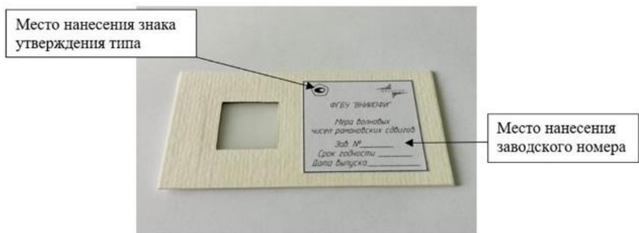
Рисунок 1 – Общий вид меры волновых чисел рамановских сдвигов
