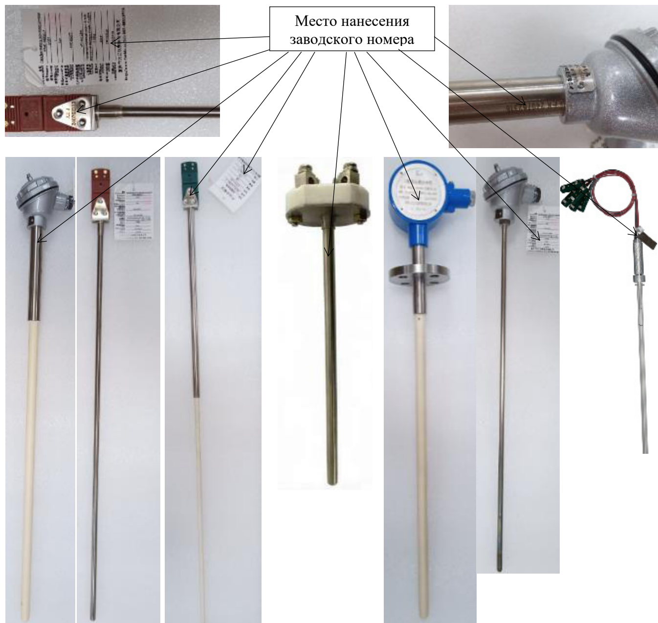
Рисунок 2 – Общий вид ТП с указанием мест нанесения заводского номера
